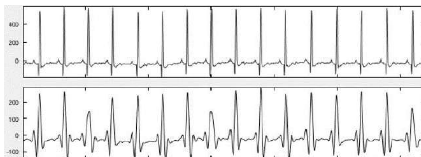
Рис. 2 – оцифрованный кардиосигнал и результат его вейвлет-преобразования
